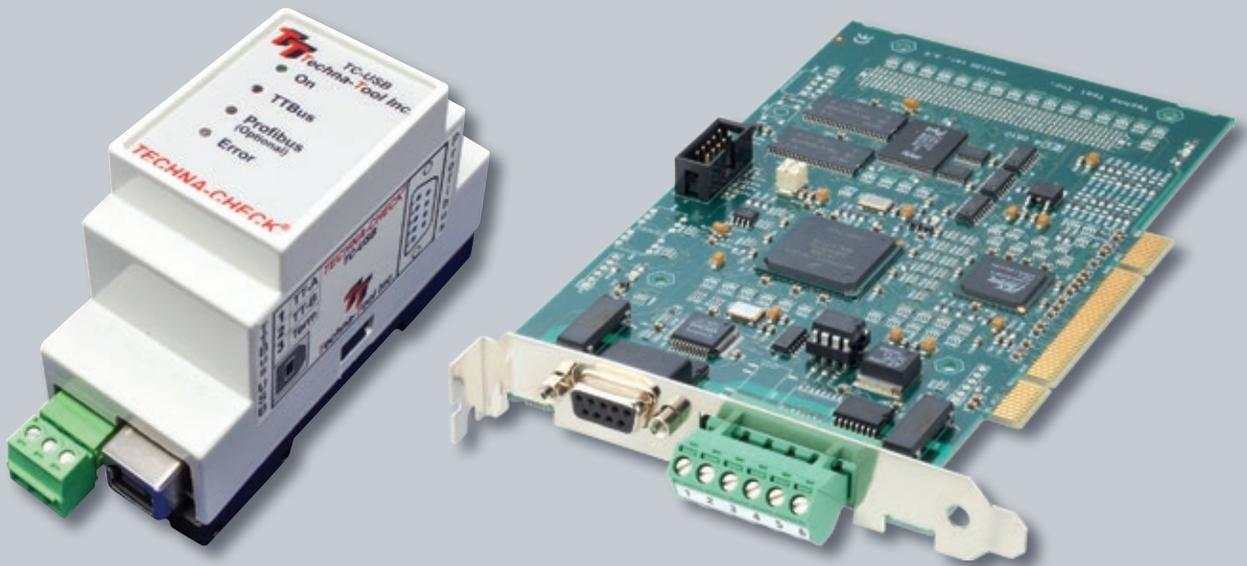
Los sistemas pueden interactuar con el control de la máquina, empleando USB y PCI y operando en ambiente Windows, o desde una computadora de forma independiente. Ellos son capaces de monitorear hasta 128 diferentes procesos de maquinado por sensor y puede conectarse hasta a 20 canales/sensores en una sola unidad.
